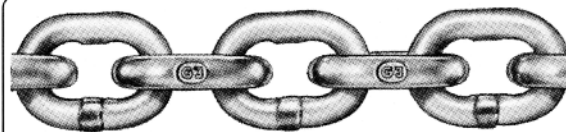
La Chaîne Grade 30 est embossée "G3" ou "G30" sur chaque maillon de 5/16" et plus
